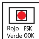
**Obs.:** en PCI /3, el LED verde indica modo no supervisado (OOK) y el LED rojo indica modo supervisado (FSK).
