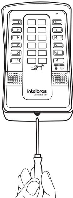
1. Afloje el tornillo de la parte inferior de la tapa frontal con la llave L Torx suministrada en el kit de fijación. Retire la tapa frontal del Collective i para acceder a los orificios de fijación y a los conectores de instalación; Utilice un destornillador para hacer palanca y soltar la tapa frontal.
