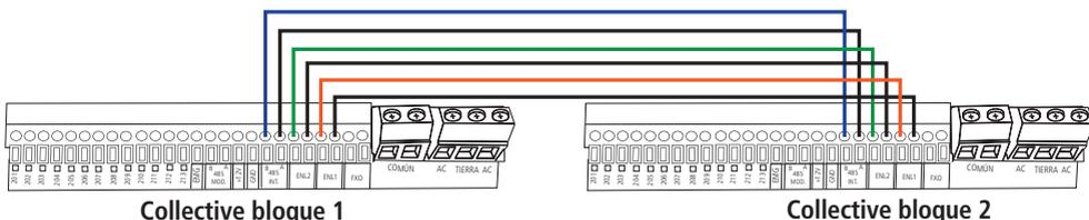
**Obs.:** utilizando la topología en cascada, este dispositivo puede conectarse a una distancia de hasta 1.000 metros medidos desde el Collective principal hasta el último Collective esclavo, siempre que se utilicen cables de buena calidad que no superen los 250 Ohmios.
