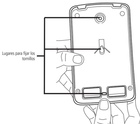
4. Fije el Collective i utilizando los orificios que se muestran en la imagen de al lado;
