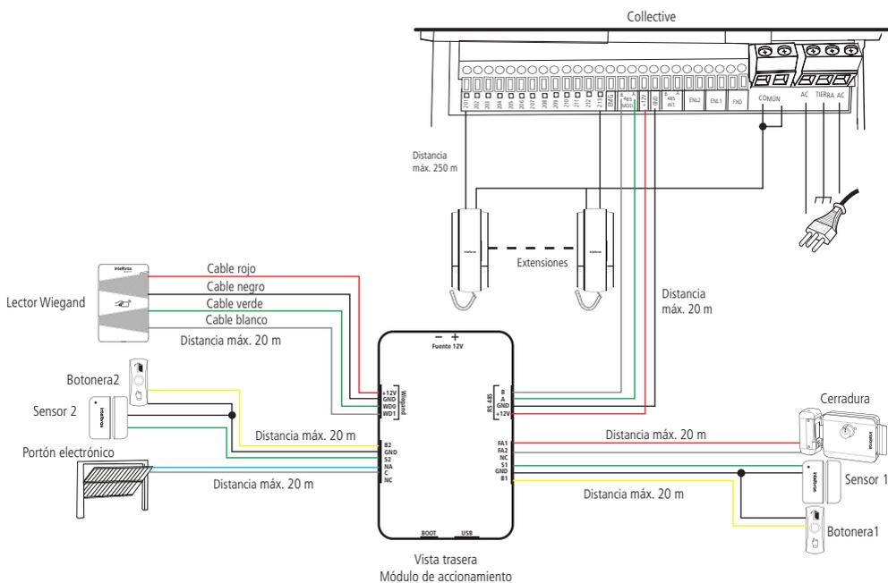
Para instalaciones donde el módulo variador se instale hasta a 1000 m de distancia del Collective:
