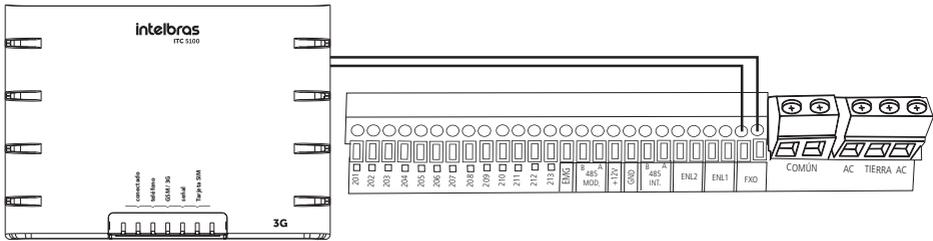
El desvío de llamadas puede realizarse con ayuda de una interfaz celular con salida FXS o un ATA. Para utilizar esta función, se debe programar el Desvío de Llamadas en el Collective i a través de la extensión o el TPI.
