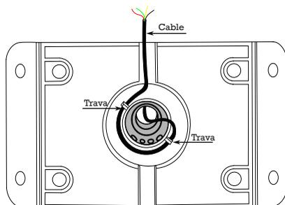
**Obs.** es importante utilizar los seguros de fijación del cable, ya que evitan que entre agua en el sensor.
